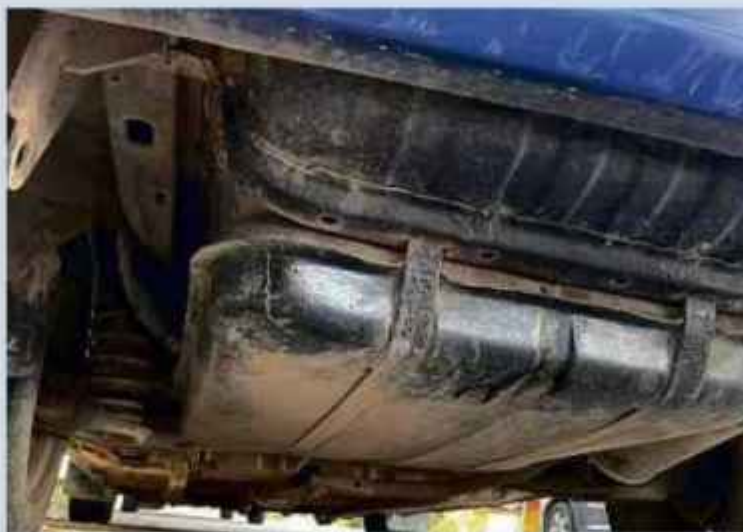
Tangki kenderaan yang diubah suai untuk seludup bahan api.
