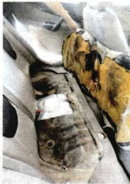
Pemeriksaan ke atas sebuah kereta Proton Waja membawa kepada penemuan tangki yang telah diubah suai sekali gus melepasi kapasiti asal.
