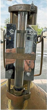
执法人员使用碳化硅检测仪器进行精密测试，结果显示油泵输出的油量均符合法定误差范围。
