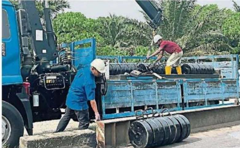
执法人员指示在罗里上放置砝码，以检查油棕收购站的磅秤精准度，没有“吃秤头”嫌疑。（内贸部提供）
