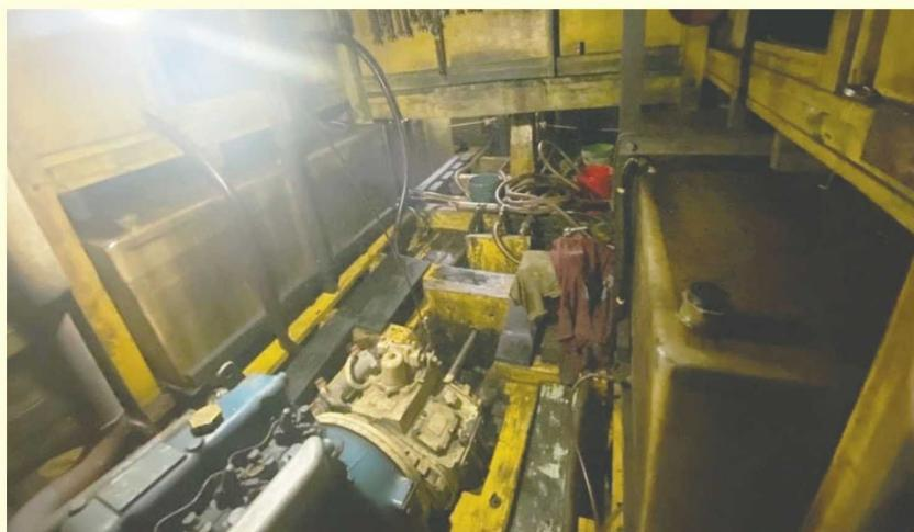
UBAH SUAI .... Bot tunda berkenaan diubahsuai untuk menampung minyak diesel berkapasiti tinggi.
