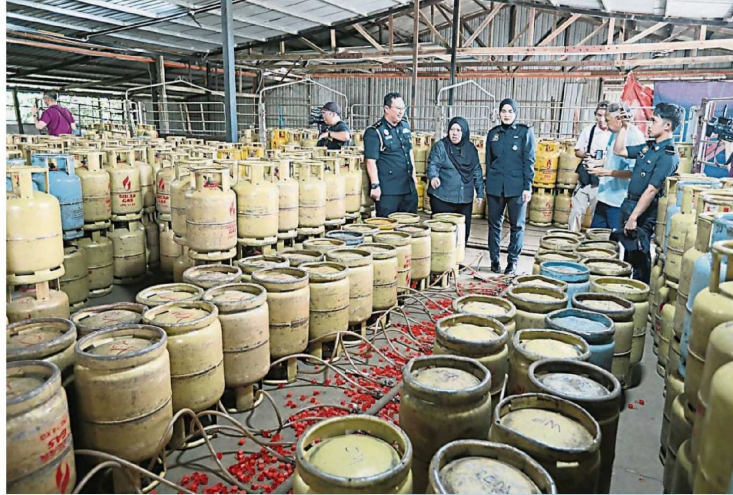
柔州与内贸部总部在行动中共起获1357个煤气桶。不法分子将津贴煤气桶倒置, 将桶内的液化石油气通过用具和管线输送到油气槽内。现场还可看到煤气从煤气桶顶部泄露, 同时嗅到煤气味。
